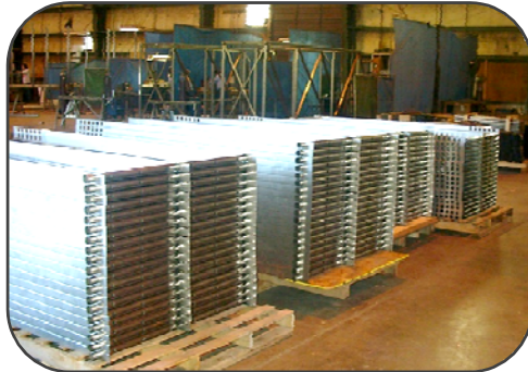
CNC punch 통한 경사판 제작
